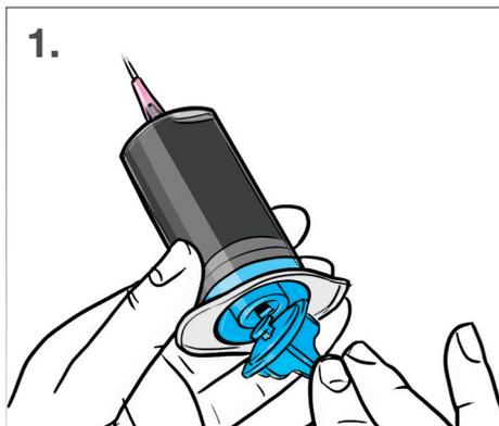
1. Zum Befüllen einer Patrone ist eine Spritze mit Tinte notwendig. Öffnen Sie dazu die Kappe eines der beiliegenden Tintenbehälter, die gleichzeitig als Spritzen dienen. Stecken Sie nun die beiliegende stumpfe Nadel mit einer Drehbewegung auf die Öffnung. Fixieren Sie mit Zeigefinger und Daumen den unteren Teil des Tintenbehälters und drehen Sie entgegen dem Uhrzeigersinn den beiliegenden Drücker unten in die Vorrichtung.
