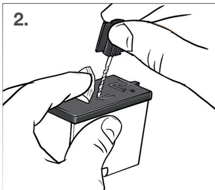
2. Lösen Sie zunächst den Aufkleber von der Oberseite der Patrone ab und bohren Sie mit dem beiliegenden Werkzeug die drei bereits vorhandenen Öffnungen weiter auf.
