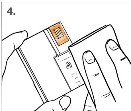
4. Zum Schluss reinigen Sie die Düsenöffnung mit einem Tuch bis sie deutlich zu sehen ist. Die wiederbefüllte Patrone kann nun in den Drucker eingesetzt werden.
