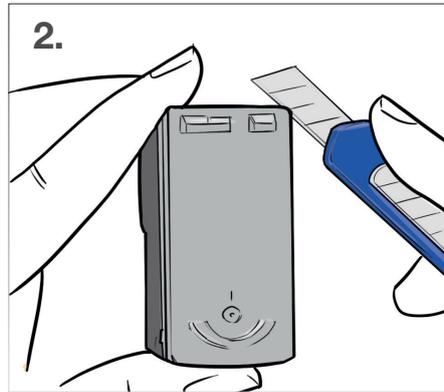
**2.** Hebeln Sie zunächst behutsam den Deckel von der Patrone mithilfe eines Messers oder Schraubendrehers ab.
