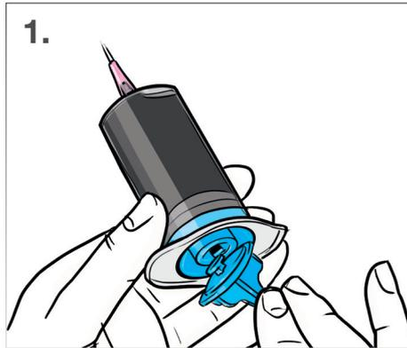
**1.** Zum Befüllen einer Patrone ist eine Spritze mit Tinte notwendig. Öffnen Sie dazu die Kappe eines der beiliegenden Tintenbehälter, die gleichzeitig als Spritzen dienen. Stecken Sie nun die beiliegende stumpfe Nadel mit einer Drehbewegung auf die Öffnung. Fixieren Sie mit Zeigefinger und Daumen den unteren Teil des Tintenbehälters und drehen Sie entgegen dem Uhrzeigersinn den beiliegenden Drucker unten in die Vorrichtung.
