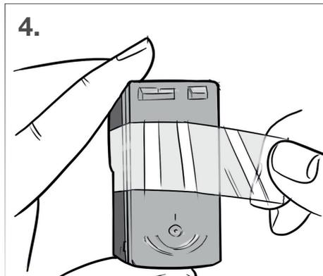
**4.** Zum Schluss befestigen Sie den zuvor abgenommenen Deckel wieder auf der Patrone mit einem Klebestreifen. Streichen Sie die Patrone auf einem Tuch hin und her bis der Düsenabdruck deutlich zu sehen ist. Die wiederbefüllte Patrone kann nun in den Drucker eingesetzt werden.
