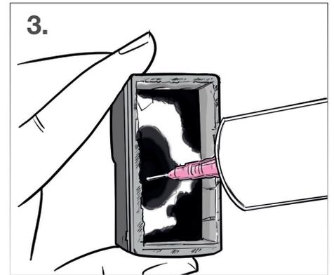
**3.** Als nächstes stecken Sie die Spritze in den jeweiligen Schwamm und befüllen die Tintenkamern langsam und vorsichtig bis zur vollständigen Sättigung. Achten Sie bei diesem Vorgang darauf, nicht die Schicht darunter zu beschädigen. Entnehmen Sie danach wieder rund 1 ml mithilfe der Spritze.
